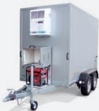
KK3015/27 kølekasse med nødstrømsaggregat i en aflåselig kasse
